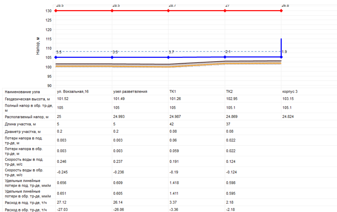
Рисунок 6 – гидравлические режимы работы котельной 21-34 с. Дивное ул. Вокзальная,16
